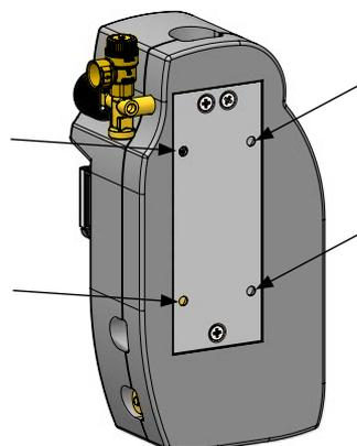
Staffa posteriore per il fissaggio del gruppo a muro o sul bollitore.
