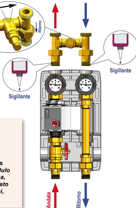
**Attenzione:** il gruppo by-pass deve essere assemblato al modulo assicurando la tenuta idraulica, utilizzando un sigillante applicato sul filetto dei due bocchettoni, come illustrato in figura.
