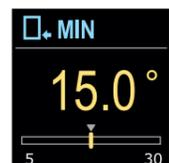
Mit den Tasten ⊖ und ⊕ bestimmen Sie die untere Grenzwerteinstellung der gewünschte Temperatur im Kühlbetrieb. Bestätigen Sie die Einstellung mit der Taste Ⓞ.
