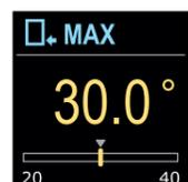
Mit den Tasten ⊖ und ⊕ können Sie den oberen Grenzwert der gewünschte Temperatur im Kühlbetrieb festlegen. Bestätigen Sie die Einstellung mit der Taste Ⓞ.
