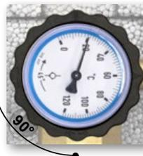
Für Wartungsarbeiten den Kugelhahn komplett schließen, indem der Drehknopf 90° im Uhrzeigersinn gedreht wird.
