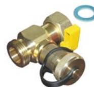
Mittels dieses speziellen "Solar"anschlusses kann die Befüllung der Anlage sehr leicht durchgeführt werden. Muss zwischen dem Schlauch (optional) und dem Ausdehnungsgefäß installiert werden.
